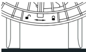
拆卸:按住風扇機身，向左旋轉風扇罩後即可取出風扇罩方便清潔。
